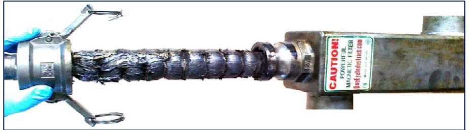
IL MAGNETIK BASIC 14 HYDRAULIC è un'unità carrellata particolarmente indicata per la doppia filtrazione di lubrificanti altamente inquinati da particolato metallico.
