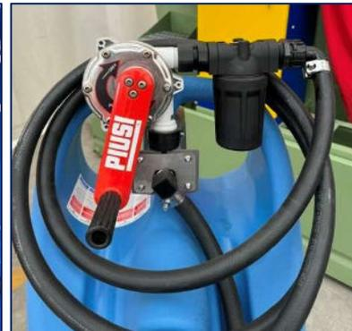
Il BLUE PURE FILTER è un filtro specificamente progettato e costruito per purificare efficacemente l'AD Blue® durante la fase di rifornimento.
